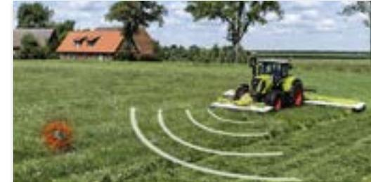
Es werden Lesegeräte entwickelt, die sowohl mobil nutzbar wie auch an landwirtschaftlichen Maschinen angebracht werden können. Somit ergibt sich eine weitere Möglichkeit der Lokalisierung durch Anbringung eines Lesegeräts an der Landmaschine selbst. Wird während der Mahd ein Signal empfangen, wird der Fahrer gewarnt. Er kann das Kitz finden und in Sicherheit bringen.
